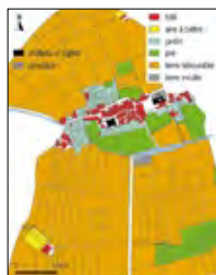
Occupation du sol et organisation du parcelaire autour du village de La Palud-sur-Verdon, d'après le cadastre de 1825.
